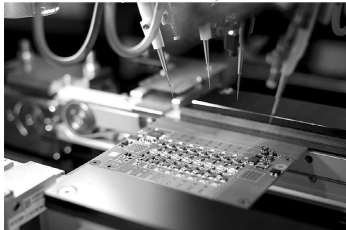
Die SMT-Fertigungslinie ermöglicht eine effektivere Produktion und eine Erhöhung der Attraktivität der Produkte. SMT steht für Surface Mounted Technology und bedeutet soviel wie Oberflächenmontage-Technologie. Dabei werden die elektrischen Komponenten direkt und vollautomatisch auf der Oberfläche einer Leiterplatte montiert. Mit dieser neuen Technologie kann die Miunske GmbH nun kompakte und höchst individuelle Leiterplatten in kürzester Zeit herstellen.
